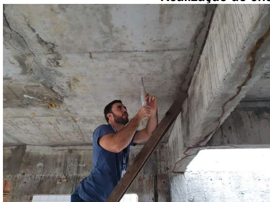
Realização do ensaio com esclerômetro
