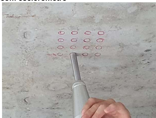
Realização do ensaio com esclerômetro
